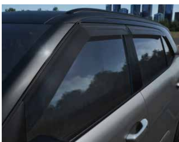
Calha de chuva
