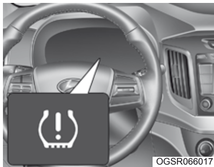
Indicador de pressão baixa do pneu / TPMS
