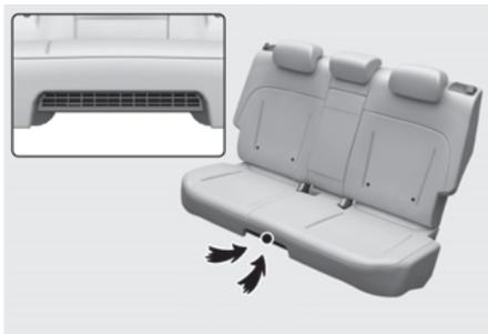
O duto de resfriamento da bateria híbrida está localizado abaixo do centro do assento traseiro. O duto de resfriamento resfria a bateria híbrida. Se o duto de resfriamento da bateria híbrida estiver obstruído, a bateria híbrida pode superaquecer.
