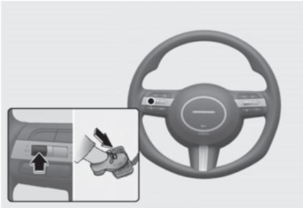
Pressione o interruptor ou pressione o pedal do freio para cancelar temporariamente o Controle de velocidade constante inteligente.
