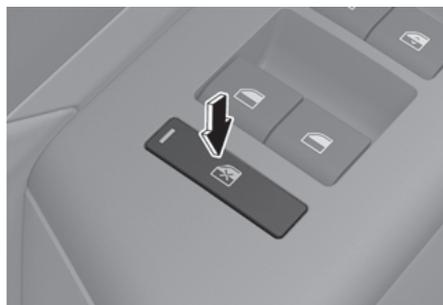
O condutor pode desativar os interruptores de vidro elétrico nas portas dos passageiros do assento traseiro pressionando o botão de trava do vidro elétrico.
