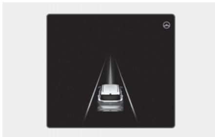
Se o veículo à frente e/ou ambas as marcações da faixa forem detectados e a velocidade do veículo for inferior a 200 km/h (120 mph), a luz indicadora verde (☺) aparecerá no painel de instrumentos e o Assistente de prosseguimento na faixa ajudará a centralizar o veículo na faixa, assistindo o volante.
