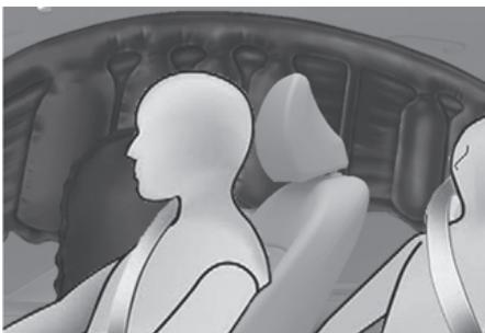
Os airbags laterais e de cortina foram projetados para inflar quando um impacto é detectado pelos sensores de colisão lateral, dependendo da gravidade do impacto resultante de uma colisão lateral.
