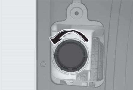
5. Remova a lâmpada do soquete pressionando-a para dentro e girando-a no sentido anti-horário.
