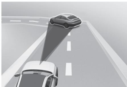
A velocidade do seu veículo poderá ser reduzida devido a um veículo na faixa ao lado.
