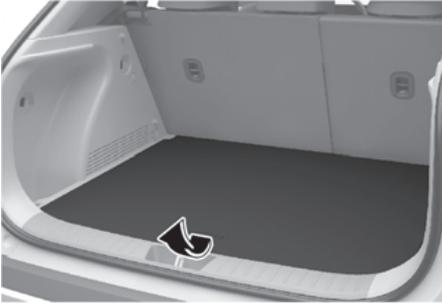
2. Remova a placa superior e insira-a completamente ao longo do sulco inferior em ambos os lados.
