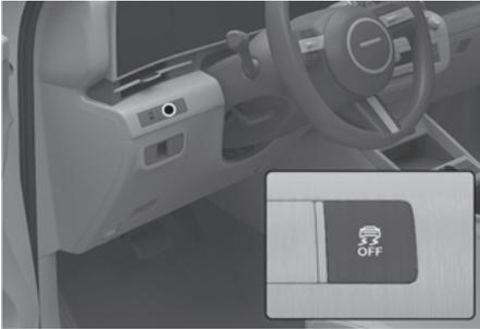
O sistema de Controle de estabilidade eletrônico ajuda a estabilizar o veículo durante manobras em curva.
