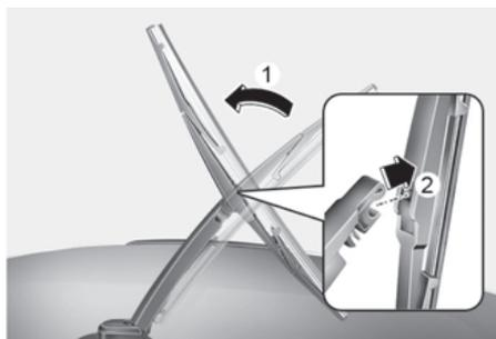
1. Levante o braço do limpador e, em seguida, gire o conjunto de palheta do limpador (1).
