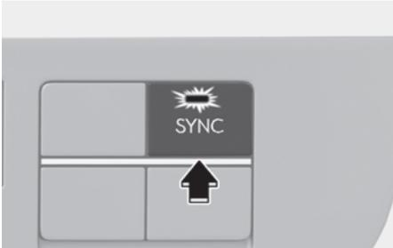
**Para ajustar igualmente a temperatura e a direção do fluxo de ar**
