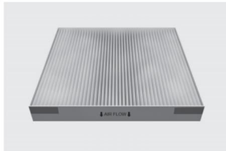
Instale um novo filtro de ar da cabine na direção correta, com o símbolo de seta (↓) virado para baixo, para evitar ruído e redução da eficiência.
