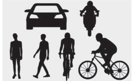
A ilustração acima mostra a imagem que a câmera de visão dianteira é capaz de detectar como veículo, veículo motorizado de duas rodas, pedestre e ciclista.
