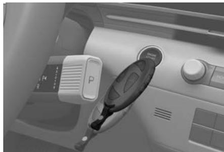
Se a bateria da chave inteligente estiver fraca ou a chave inteligente não funcionar corretamente, pressione o botão Start/Stop (Partida/Parada) do motor com a chave inteligente.
