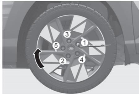
Verifique a pressão dos pneus após instalar o pneu sobressalente compacto. O pneu sobressalente compacto deve ser inflado até 60 psi (420 kPa).
