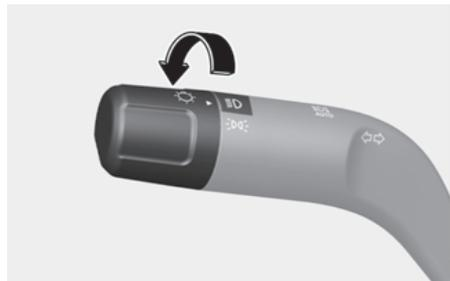
O farol, a luz de posição, a luz da placa e a lâmpada do painel de instrumentos acendem.
