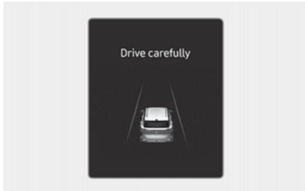
Quando o veículo for parado devido a uma frenagem de emergência, a mensagem de alerta "**Conduza com cuidado**" aparecerá no painel de instrumentos.
