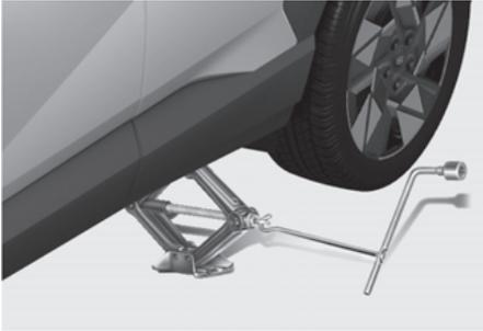
9. Afrouxe as porcas da roda com a chave de roda e remova-as com os dedos. Retire a roda dos pinos e coloque-a deitada no chão, fora do caminho. Remova qualquer sujeira ou detritos dos pinos, superfícies de montagem e pneu sobressalente.
