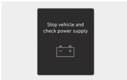
Esta mensagem aparece quando há uma falha no sistema de fornecimento de energia.
