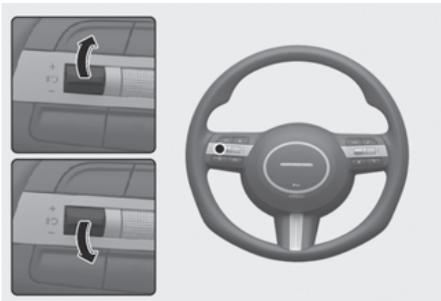
3. O limite de velocidade definido será exibido no painel de instrumentos. Caso queira ultrapassar o limite de velocidade predefinido, pressione o pedal do acelerador além do ponto de pressão para ativar a função kickdown. O limite de velocidade definido piscará e o alerta sonoro será emitido até que você retorne a velocidade do veículo para dentro do limite de velocidade.
