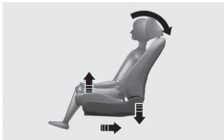
Os Assentos confortáveis de relaxamento distribuem a pressão do corpo e o peso concentrado em partes específicas do corpo que ocorrem ao sentar-se na mesma posição por um longo período de tempo. O assento alivia a fadiga e o desconforto, proporcionando a posição ideal para sentar.
