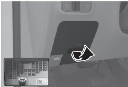
4. Consulte a etiqueta na parte interna da tampa do painel de fusíveis para localizar o fusível com suspeita de falha.
