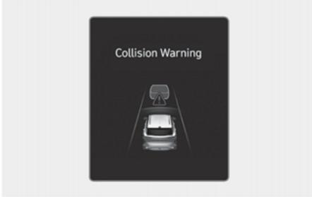
Enquanto o Controle de velocidade constante inteligente estiver em funcionamento e o risco de colisão com o veículo à frente for alto, a mensagem de alerta "**Alerta de colisão!**" aparecerá no painel de instrumentos e um alerta sonoro será emitido para alertar o condutor. Sempre fique atento à pista enquanto conduz e, se necessário, pressione o pedal do freio para reduzir sua velocidade de condução, para manter uma distância segura.
