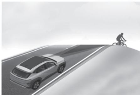
O Assistente de prevenção de colisão à frente pode não detectar um veículo, veículo motorizado de duas rodas, pedestre ou ciclista à frente ao conduzir em subidas ou descidas, afetando negativamente o desempenho dos sensores.
