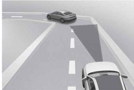
Em curvas, o Controle de velocidade constante inteligente poderá não detectar um veículo na mesma faixa e poderá acelerar até a velocidade definida. Além disso, a velocidade do veículo poderá diminuir rapidamente quando o veículo à frente for detectado de maneira repentina.
