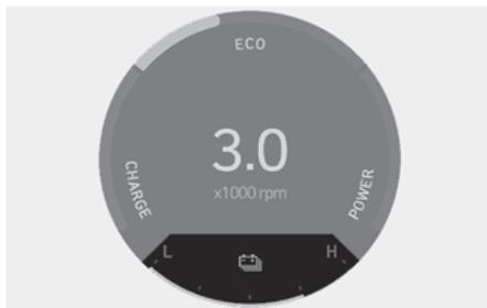
Este mostrador indica a energia restante da bateria híbrida. Se o SOC estiver próximo ao nível L (Baixo), o veículo aciona automaticamente o motor a combustão para carregar a bateria.
