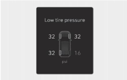
Quando o indicador de alerta do sistema de monitoramento de pressão dos pneus (TPMS) estiver aceso e uma mensagem de alerta for exibida no visor do painel de instrumentos, um ou mais pneus estão com calibração significativamente insuficiente. O indicador de posição de pressão baixa do pneu acenderá a luz de posição correspondente para indicar qual pneu está com a pressão muito insuficiente.
