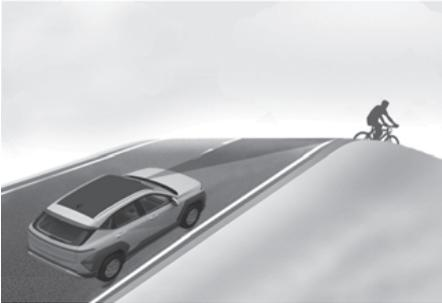
O Assistente de prevenção de colisão à frente pode não detectar veículos, veículos motorizados de duas rodas, pedestres ou ciclistas à frente ao conduzir em subidas ou descidas, afetando negativamente o desempenho dos sensores.
