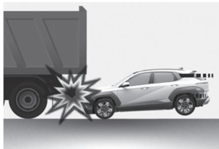
Um pouco antes do impacto, os condutores geralmente freiam com força. Uma frenagem tão forte faz com que a parte dianteira do veículo desça, causando um "mergulho de nariz". Isso é particularmente importante quando o veículo à frente tem uma maior altura do solo. Os airbags podem não inflar se o seu veículo estiver em uma condição de "mergulho de nariz", porque as forças de colisão detectadas pelos sensores podem ter sido significativamente reduzidas.
