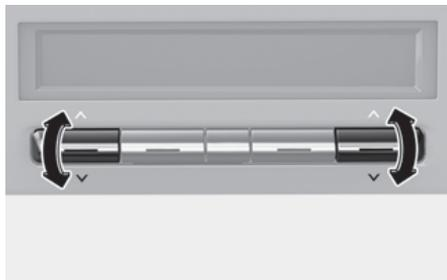
Para aumentar a temperatura, pressione o interruptor para cima. Para diminuir a temperatura, pressione o interruptor para baixo.
