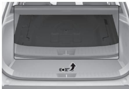
Use a bandeja de carga para organizar e armazenar pequenos itens, como ferramentas. Para usar a bandeja, levante a placa superior com a alça.
