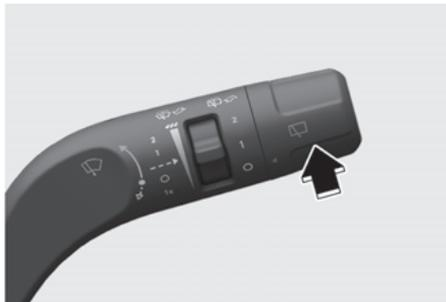
O interruptor do lavador do vidro traseiro está localizado na extremidade da alavanca do interruptor do lavador.
