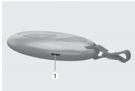
2. Remova a bateria antiga e insira uma bateria nova. Certifique-se de que a posição da bateria esteja correta. Uma bateria posicionada incorretamente pode descarregar a bateria, causando falha na chave inteligente.
