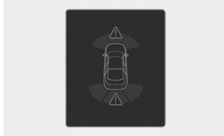
Quando o Alerta de distância de estacionamento estiver em funcionamento, se a função não estiver funcionando normalmente ou o sensor ultrassônico estiver obstruído, a luz de alerta principal (Δ) aparece na direção do sensor correspondente. Você pode verificar o alerta na visualização Utilitário no painel de instrumentos.
