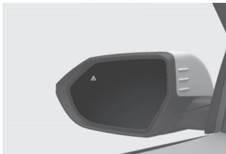
Seu veículo está equipado com espelhos retrovisores externos dos lados direito e esquerdo. Os espelhos podem ser ajustados com o interruptor de controle de ajuste dos espelhos. Ajuste os espelhos retrovisores para a posição desejada antes de conduzir. Os espelhos retrovisores externos podem ser recolhidos para ajudar a evitar danos durante a lavagem automática do veículo ou ao passar por uma rua estreita.
