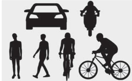
A ilustração acima mostra a imagem que a câmera de visão dianteira e o radar dianteiro são capazes de detectar como veículo, veículo motorizado de duas rodas, pedestre e ciclista.
