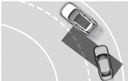
O Assistente de prevenção de colisão nos pontos cegos poderá não funcionar corretamente ao conduzir em uma pista curvada. A função poderá não detectar o veículo na faixa ao lado.
