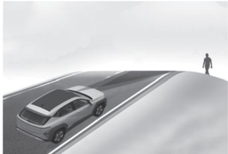
O Assistente de prevenção de colisão à frente pode detectar um veículo, veículo motorizado de duas rodas, pedestre ou ciclista na faixa ao lado ou fora da faixa ao conduzir em uma via com curvas.
