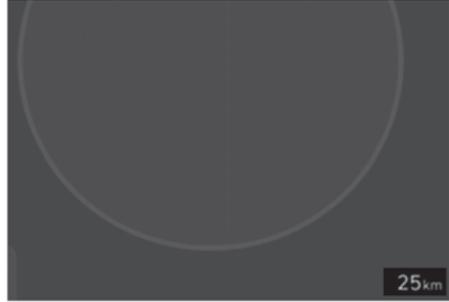
O odômetro indica a distância total que o veículo percorreu e é usado para determinar quando a manutenção periódica é necessária.
