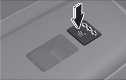
Com o motor em funcionamento, pressione o interruptor do aquecedor de assento para aquecer o assento traseiro.
