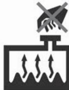
Nunca remova a tampa do reservatório de líquido de arrefecimento do motor, a tampa do radiador ou o plugue de drenagem enquanto o motor e o radiador estiverem quentes. Líquido de arrefecimento e vapor quentes podem ser expelidos sob pressão, causando lesões graves.
