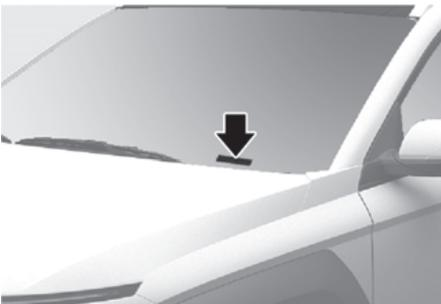
O NIV também se encontra em uma placa fixada na parte superior esquerda do painel. O número na placa pode ser visto facilmente através do para-brisa pelo lado de fora.
