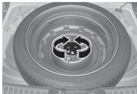
Gire o parafuso borboleta de retenção no sentido anti-horário para remover o pneu sobressalente.
