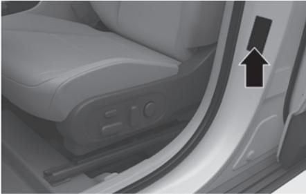
Todas as especificações (tamanhos e pressões) podem ser encontradas em uma etiqueta fixada na coluna central do lado do condutor.
