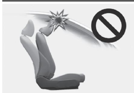
Se você reclinar o encosto do assento em direção à parte dianteira com o apoio para cabeça e a almofada do assento erguidos, o apoio para cabeça poderá entrar em contato com o quebra-sol ou com outras partes do veículo.
