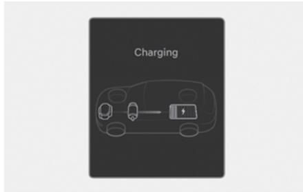
O motor a combustão carrega a bateria de alta tensão de acordo com as condições do veículo e do ambiente ao redor.
