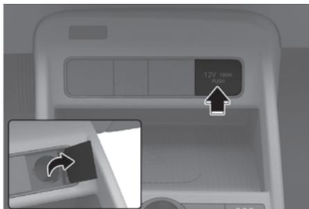
A tomada elétrica foi projetada para fornecer energia para telefones celulares ou outros dispositivos projetados para funcionar com sistemas elétricos de veículos.
