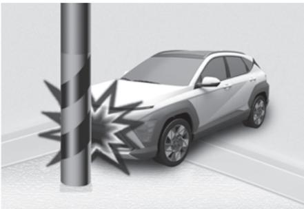
Os airbags podem não inflar se o veículo colidir com objetos como postes ou árvores, onde o ponto de impacto está concentrado e a energia da colisão é absorvida pela estrutura do veículo.
