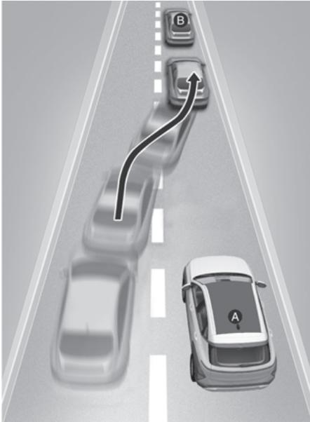
Quando um veículo muda de uma faixa adjacente para a sua faixa, ele não poderá ser detectado pelo sensor até que ele esteja no intervalo de detecção do sensor. O sistema de regeneração inteligente poderá não detectar imediatamente o veículo quando o seu veículo mudar de faixa bruscamente.
