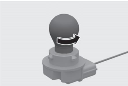
6. Instale uma lâmpada nova e reinstale na ordem inversa.
