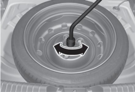
Se for difícil soltar o parafuso de retenção do pneu manualmente, você pode soltá-lo facilmente usando a chave de roda.
