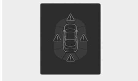
Quando o Alerta de distância de estacionamento estiver em funcionamento, se a função não estiver funcionando normalmente ou o sensor ultrassônico estiver obstruído, a luz de alerta principal ( $\Delta$ ) aparece na direção do sensor correspondente. Você pode verificar o alerta na visualização Utilitário no painel de instrumentos.
