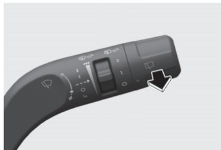
Na posição O (OFF), puxe a alavanca suavemente na sua direção para borrifar o fluido de lavagem no para-brisa e acionar os limpadores por 1 a 3 ciclos. O pulverizador e o limpador continuarão funcionando até você soltar a alavanca. Se o lavador não funcionar, pode ser necessário adicionar fluido de lavagem ao reservatório do fluido de lavagem.
