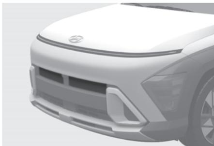
O sistema de defletor ativo de ar controla o defletor de ar embaixo do para-choque dianteiro, para resfriar as peças do veículo e melhorar a eficiência energética.
