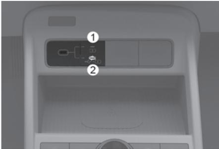
Pressione o botão de seleção da porta USB com o motor em funcionamento. Pressione a parte superior do botão (1) para carregar um dispositivo eletrônico. Pressione a parte inferior do botão (2) para carregar e ouvir música com um dispositivo de armazenamento de mídia. A porta USB pode ser usada depois que qualquer uma das luzes indicadoras acender.
