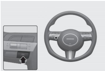
Com o veículo ligado, pressione rapidamente o botão do Assistente de condução na faixa (☺) localizado no volante, para ativar o Assistente de prosseguimento na faixa. A luz indicadora cinza ou verde (☺) aparecerá no painel de instrumentos.
