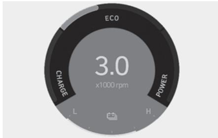
O mostrador do sistema híbrido indica se a condição de condução atual é eficiente em termos de combustível ou não.
