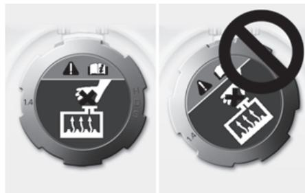
2. Certifique-se de que as pequenas protuberâncias dentro da tampa do líquido de arrefecimento estejam firmemente encaixadas.
