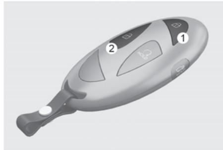
Você ainda pode controlar o movimento dos vidros com o veículo desligado ao pressionar o botão de Travamento da porta (1) ou o botão de Destravamento da porta (2).
