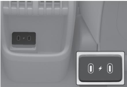
O carregador USB foi projetado para recarregar baterias de dispositivos eletrônicos de pequeno porte usando um cabo USB.
