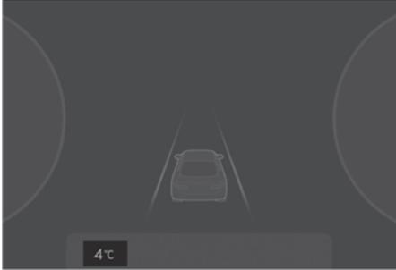
A temperatura ambiente externa aparece na parte inferior do visor do painel de instrumentos. A temperatura aparece em Celsius ou Fahrenheit, dependendo das unidades selecionadas no menu de configurações no painel de instrumentos ou no sistema de informação e entretenimento.
