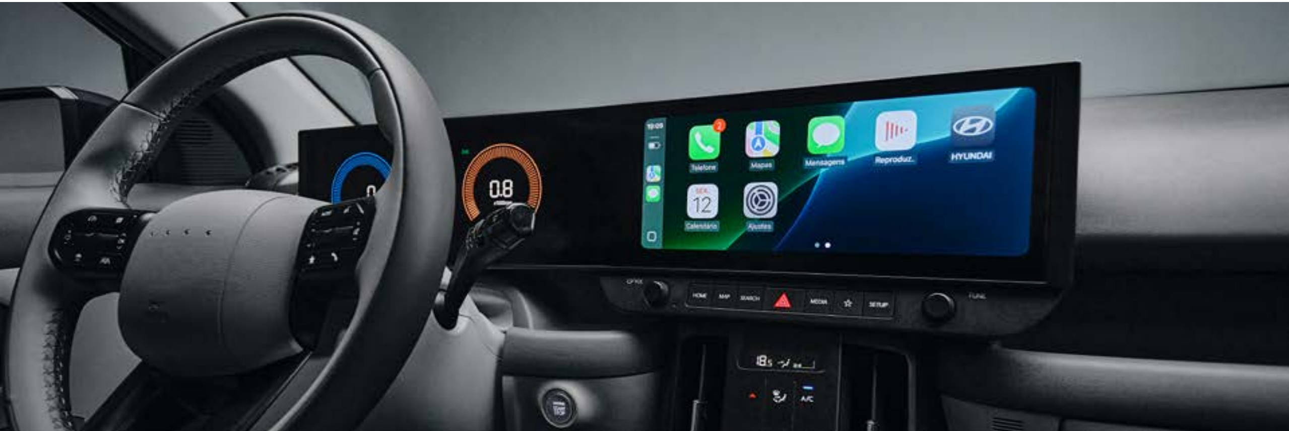
Display panorâmico Composto do painel digital integrado à central multimídia, ambos com 12,3”.
