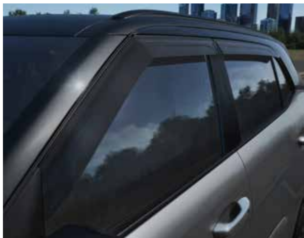
Calha de chuva
