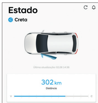
Condição das portas (gráfico), quantidade de combustível disponível no tanque e autonomia estimada pelo computador de bordo
