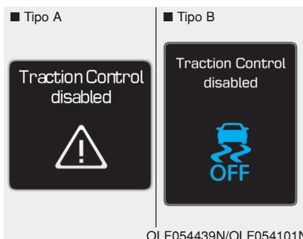
Pressione o botão “ESP OFF” brevemente (a luz indicadora “ESP OFF” e a mensagem se acendem). Neste estado, a função de controle do motor não aciona. A função de controle de tração não aciona, funcionando apenas o controle dos freios.
