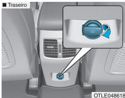
O carregador USB destina-se ao carregamento de baterias de pequenos dispositivos elétricos usando um cabo USB.
