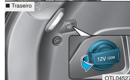
A tomada elétrica destina-se a fornecer energia elétrica a telefones celulares ou outros aparelhos concebidos para funcionarem com sistemas elétricos de automóveis. Os dispositivos devem consumir menos de 120 W (Watts) com o motor funcionando.
