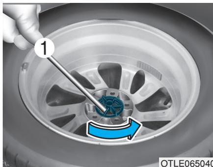
Se o parafuso de retenção do pneu sobressalente estiver difícil de retirar, use o manípulo do macaco para facilitar a remoção.
