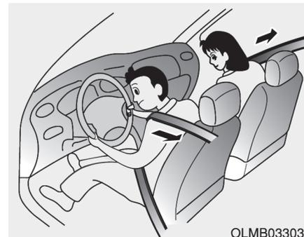
Seu veículo é equipado com pré-tensores dos cintos de segurança do condutor e do passageiro dianteiro. Em caso de colisão frontal, os pré-tensores dos cintos de segurança podem ser ativados juntamente com os *airbags*, dependendo do nível de gravidade da colisão.
