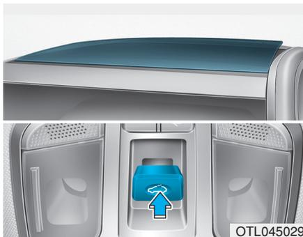
Se a alavanca de controle do teto solar for empurrada para cima, o vidro do teto solar abre e em seguida se inclina.
