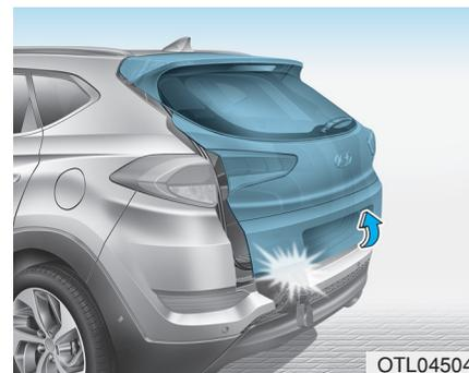
Durante o movimento de abertura e fechamento da tampa do porta-malas, se o porta-malas elétrico for bloqueado por um objeto ou parte do corpo, o sistema detecta a presença de um obstáculo.
