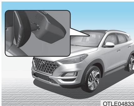
O desembaçamento automático reduz a possibilidade de embaçamento do para-brisas através de sensores que detectam automaticamente a umidade na face interior do para-brisas.
