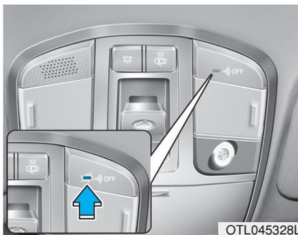
O sensor de invasão detecta movimentos dentro do veículo e a inclinação do veículo depois de trancado.
