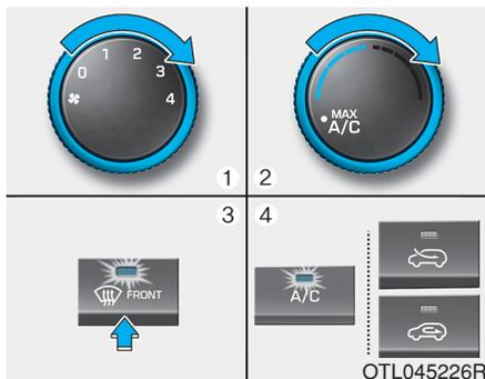
1. Coloque o controle de velocidade da ventilação na posição máxima (extrema direita).
