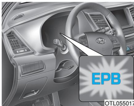
Se o indicador de avaria do EPB permanecer ligado, acender ao conduzir ou não ligar quanto o botão de partida/parada do motor for colocado na posição "ON", o EPB pode estar avariado.
