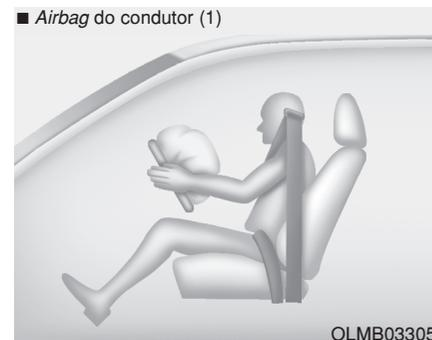
Quando SRSCM detecta um impacto suficientemente grave na parte frontal do veículo, ele aciona automaticamente os *airbags*.
