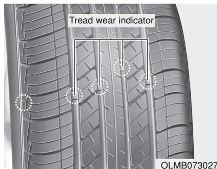
Se o pneu desgastar uniformemente, o indicador de desgaste da banda de rodagem aparece como uma linha sólida por toda a banda. Isso mostra que há menos de 1,6 mm (1/16 polegadas) da banda de rodagem restante no pneu. Quando isso acontecer, substitua o pneu.
