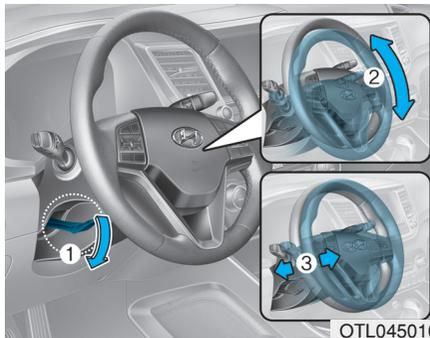
Puxe para baixo a alavanca de bloqueio (1) na coluna de direção e ajuste o ângulo (2) e posição (3) do volante. Mova o volante de forma que fique apontado para seu peito e não para seu rosto. Certifique-se de que as luzes e mostradores do painel de instrumentos estão visíveis.
