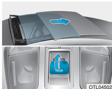
Se a alavanca de controle do teto solar for puxada para trás, o teto solar desliza até abrir totalmente e então o vidro do teto solar abre totalmente. Para interromper o movimento do teto solar a qualquer momento, puxe ou empurre a alavanca de controle do teto solar momentaneamente.
