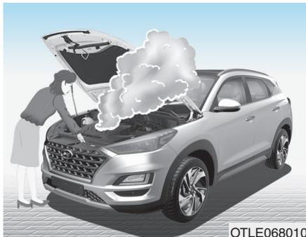
Se o indicador de temperatura indicar superaquecimento e você notar perda de potência ou ouvir um zumbido ou leves batidas, o motor pode estar superaquecendo. Se isso ocorrer:
