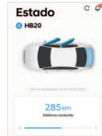
Condição das portas (gráfico), quantidade de combustível disponível no tanque e autonomia estimada pelo computador de bordo
