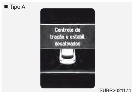
Pressione e segure continuamente o botão ESC OFF por mais de 3 segundos. A luz indicadora do ESC OFF e/ou a mensagem "Controle de Tração & ESC desativados" acendem e soa um alerta de advertência. Nesta condição, as funções de controle de tração do ESC (gestão do motor) e a função de controle do freio do ESC (gestão da frenagem) são desativadas.
