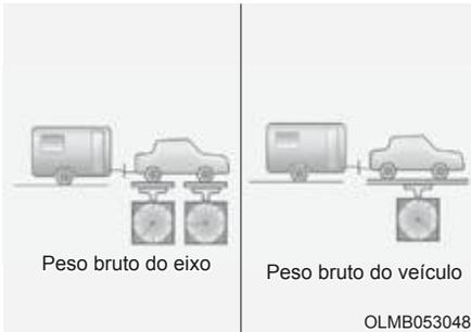
A carga sobre o engate é um peso importante para medir porque ela afeta o Peso Bruto do Veículo (GVW). A carga sobre o engate deve pesar no máximo 10% do peso total do trailer carregado, dentro dos limites permitidos de carga máxima sobre o engate do trailer.
