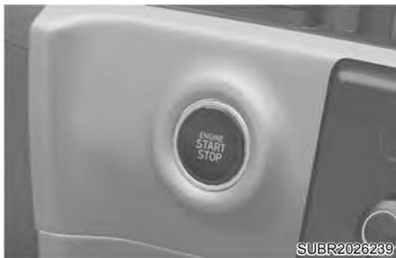
Com o interruptor de ignição desligado e todas as portas travadas, quando o motorista destravar o veículo com a chave inteligente e abrir a porta, o botão de Start/Stop acenderá por 30 segundos.
