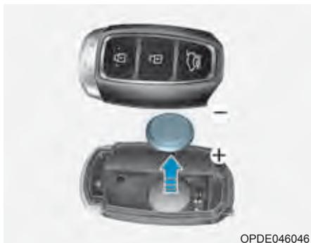
Se a chave inteligente não estiver funcionando corretamente, tente substituir a bateria por uma nova.
