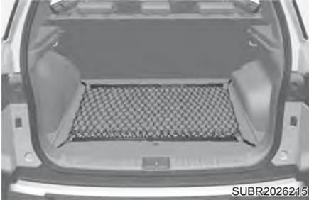
Para evitar que itens mudem de posição na área de carga, você pode usar os quatro suportes localizados na área de carga para prender a rede de bagagem.
