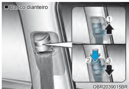
Para ajustar a altura da fixação do cinto, levante ou abaixe o ajustador de altura até à posição apropriada.
