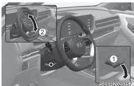
Para mudar a inclinação e a altura do volante de direção:
