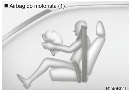
Os airbags estão localizados no centro do volante de direção e no painel dianteiro do lado do passageiro, acima do porta-luvas. Quando o SRSCM detecta um impacto suficientemente grave na frente do veículo, ele aciona automaticamente os airbags dianteiros.
