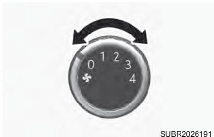
Gire o botão à direita para aumentar a velocidade do ventilador e o fluxo de ar. Gire o botão à esquerda para diminuir a velocidade do ventilador e o fluxo de ar.
