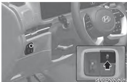
O sistema de Controle Eletrônico de Estabilidade (ESC) ajuda a estabilizar o veículo ao manobrar em curvas.
