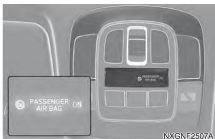
Para reativar o airbag do passageiro dianteiro insira a chave ou dispositivo semelhante no interruptor LIGA/DESLIGA do airbag do passageiro dianteiro e coloque na posição LIGA. O indicador ON do airbag do passageiro (☑) acenderá.
