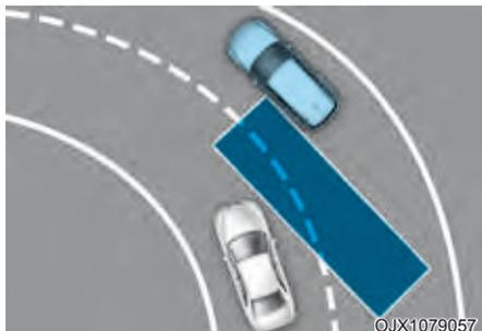
O Sistema de Alerta e Assistente de Ponto Cego pode não funcionar adequadamente ao dirigir em uma curva. A função pode não detectar o veículo da faixa ao lado.
