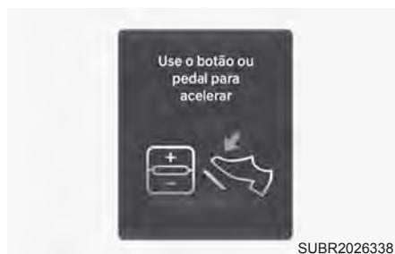
Para retomar o movimento do veículo, pressione o interruptor + ou -, ou então pressione o pedal do acelerador.
