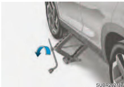
8. Encaixe a alavanca no macaco e gire-a no sentido horário, levantando o veículo até que o pneu desencoste do solo. Certifique-se que o veículo esteja estável sobre o macaco.
