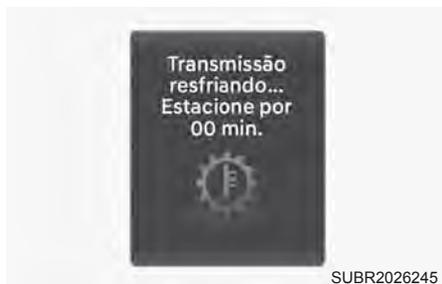
Se você mover o veículo para um local seguro e mudar a marcha para P (Estacionamento) com o motor ligado, a mensagem de aviso acima aparecerá.
