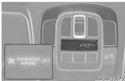
Para desativar o airbag do passageiro dianteiro insira a chave ou dispositivo semelhante no interruptor LIGA/DESLIGA do airbag do passageiro dianteiro e coloque na posição DESLIGA. O indicador OFF do airbag do passageiro (☒) acenderá e continuará aceso até que o airbag do passageiro dianteiro seja reativado.
