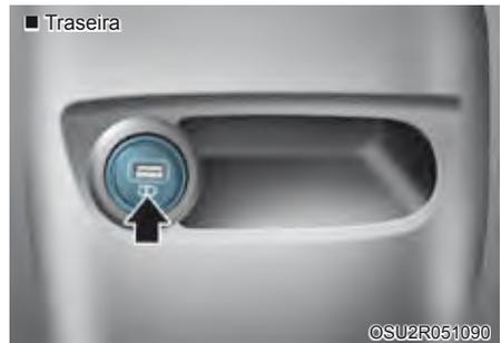
O carregador USB é projetado para recarregar baterias de dispositivos elétricos pequenos usando um cabo USB.
