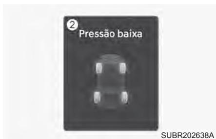
Indicador de pressão baixa do pneu / Indicador de mau funcionamento do TPMS
