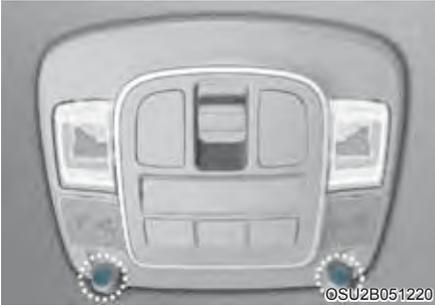
O sensor de intrusão/inclinação detecta movimento no interior do veículo e inclinação do veículo após o travamento.
