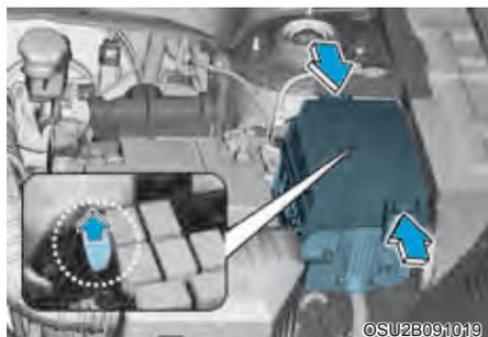
3. Remova o fusível suspeito para fora. Utilize o extrator de fusíveis localizado no painel de fusíveis do compartimento do motor.
