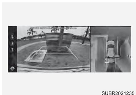
O Monitor de Visão Externa 360° pode ajudar no estacionamento usando as câmeras instaladas no veículo e mostrando imagens ao redor do veículo através da tela do sistema infotainment.
