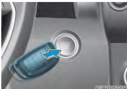
Se a bateria da chave inteligente estiver fraca ou a chave inteligente não funcionar corretamente, você pode dar partida no motor pressionando o botão de Start/Stop do motor com a chave inteligente na direção da figura acima.
