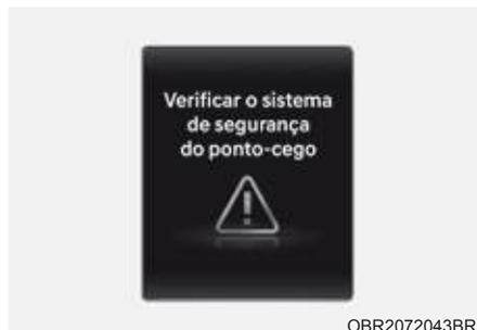
Quando o Alerta de Saída Segura não estiver funcionando adequadamente, aparecerá por vários segundos no painel de instrumentos a mensagem de advertência 'Verifique o sistema de Segurança de Ponto Cego' e a luz principal de advertência (⚠) acenderá no painel de instrumentos. Se a luz principal de advertência acender, recomendamos levar seu veículo à concessionária autorizada Hyundai Motor Brasil (HMB) para inspeção.
