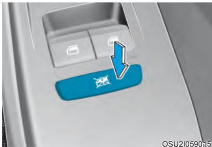
O motorista pode desabilitar os interruptores dos vidros elétricos das portas dos passageiros traseiros pressionando o botão de bloqueio dos vidros.
