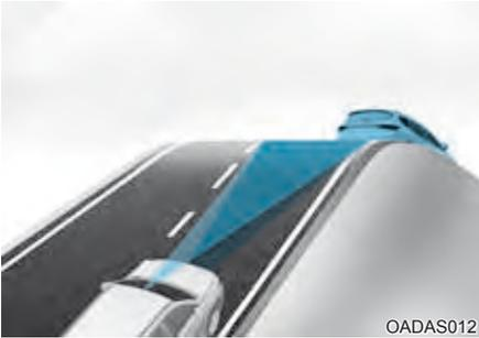
Durante condução em subidas ou descidas, o Controle de Cruzeiro Inteligente pode não detectar um veículo em movimento em sua faixa e então seu veículo poderá acelerar até a velocidade ajustada. A velocidade do veículo também diminuirá rapidamente quando o veículo à frente for detectado repentinamente.
