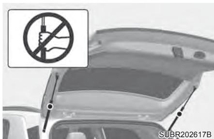
Não segure nas molas a gás (levantadores) que suportam a tampa traseira. Lembre-se que a deformação da peça pode causar dano ao veículo e risco de ferimento.
