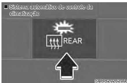
O desembaçador aquece o vidro para remover geada, neblina e gelo fino do interior e exterior do vidro traseiro enquanto o motor estiver funcionando.
