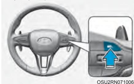
2. Pressione e segure o botão de Assistência à Condução até a velocidade desejada. O indicador ( CRUISE) de velocidade ajustada e Controle de Cruzeiro acenderá no painel de instrumentos.
