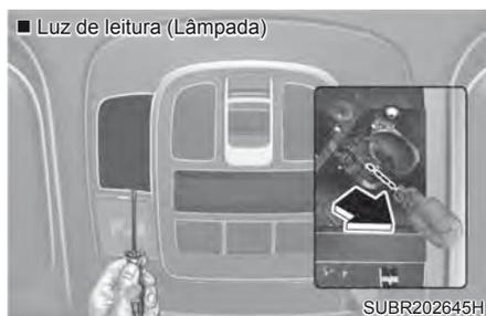
1. Remova a cobertura frontal e encontre 2 parafusos de fixação à carroceria.
