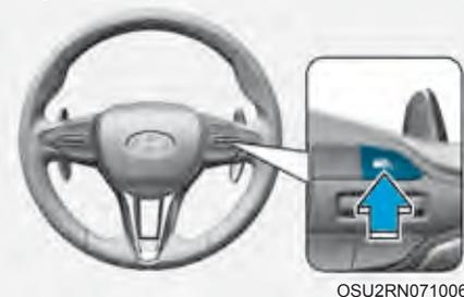
1. Pressione e segure o botão de Assistência à Condução até a velocidade desejada. O indicador ( LIMIT ) de Assistência Manual do Limite de Velocidade ativado acenderá no painel de instrumentos.
