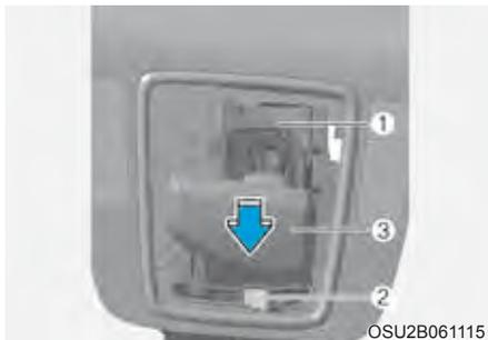
1. Dentro de 3 minutos após desligar o veículo, mova a alavanca para N (Neutro) com o pedal do freio pressionado.
