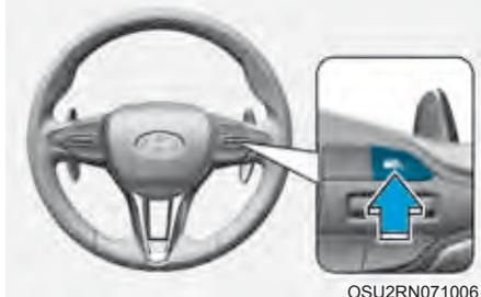
Pressione o botão de Assistência à Condução para desligar a Assistência Manual do Limite de Velocidade. O indicador ( ) de Assistência Manual do Limite de Velocidade ativado apagará.
