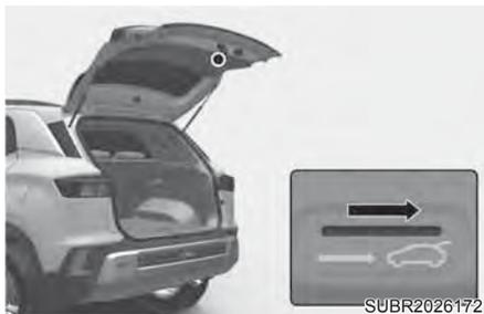
Seu veículo é equipado com uma alavanca de Liberação de Segurança de Emergência da tampa traseira localizada no fundo da tampa traseira. Quando alguém ficar preso inadvertidamente no compartimento de bagagem, a tampa traseira poderá ser aberta como segue:
