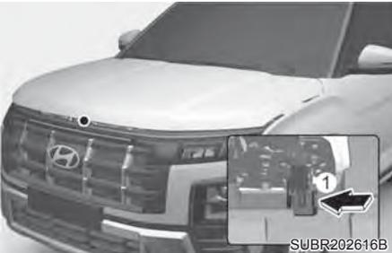
3. Vá para a frente do veículo, levante ligeiramente o capô, puxe a trava secundária (1) na parte interna do centro do capô e levante o capô (2).
