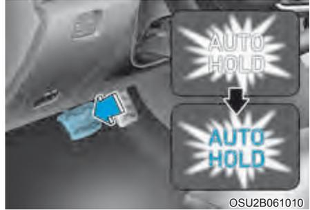
2. Quando você parar totalmente o veículo pressionando o pedal do freio, o AUTO HOLD mantém a pressão do freio para manter o veículo estacionado. O indicador muda de branco para verde.
