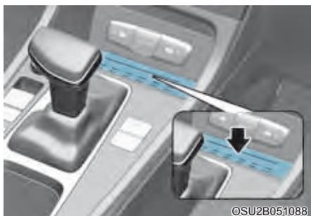
Em determinados modelos, o veículo vem equipado com um carregador sem fio para celular.
