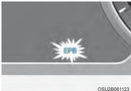
Esta luz de advertência acende se o botão de Start/Stop do motor for mudado para a posição ON e apaga em cerca de 3 segundos se o sistema estiver funcionando normalmente.
