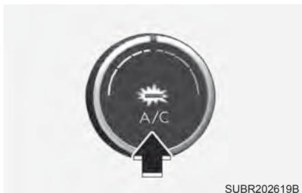
Para ligar o sistema de ar condicionado, pressione o botão "A/C" (a luz indicadora acenderá). Para desligar o sistema de ar condicionado, pressione novamente o botão.
