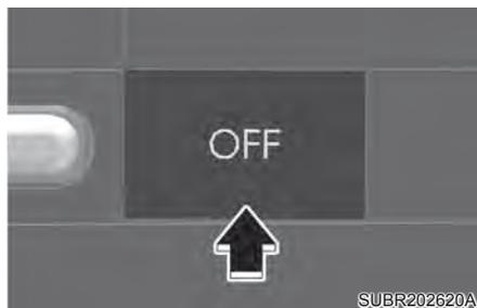
Para desligar o sistema de controle de climatização, pressione o botão OFF. Você pode continuar utilizando o modo e os botões de entrada de ar enquanto o interruptor de ignição estiver na posição ON.
