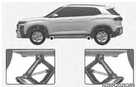
7. Posicione o macaco na posição mais próxima designada debaixo do chassi para levantar o pneu que irá substituir. Os pontos de apoio do macaco são placas soldadas à carroceria com duas linguetas e um ponto levantado. Nunca use o macaco em outra posição ou parte do veículo.
