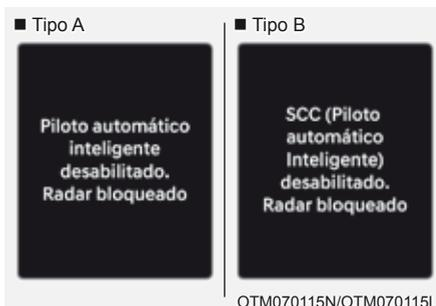
Quando a tampa do radar dianteiro ou o sensor estiver recoberto por neve, chuva ou material estranho, o desempenho de detecção pode ser reduzido e limitado temporariamente ou desativar o Controle de Cruzeiro Inteligente.
