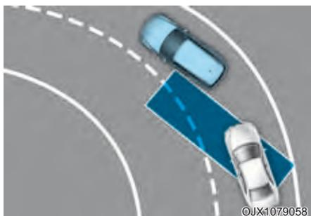
O Sistema de Alerta e Assistente de Ponto Cego pode não funcionar adequadamente ao dirigir em uma curva. A função pode não reconhecer o veículo na mesma faixa.
