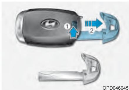
Pressione e segure o botão de liberação (1) e remova a chave mecânica (2). Insira a chave mecânica no orifício da chave da porta.
