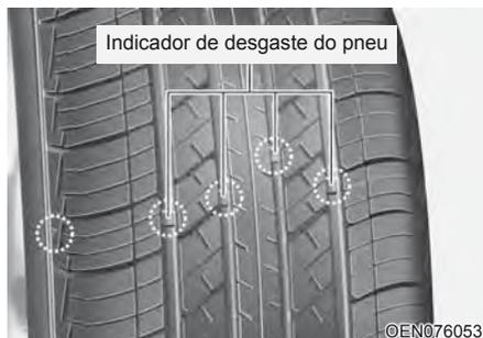
Se um pneu estiver gasto uniformemente, um indicador de desgaste aparecerá como uma faixa sólida atravessando a banda de rodagem. Isso mostra que resta menos de 1,6 mm da banda de rodagem no pneu. Substitua o pneu quando isso acontecer.
