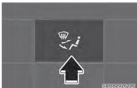
O botão de seleção de modo controla a direção do fluxo de ar através do sistema de ventilação.
