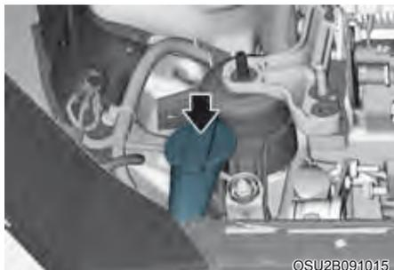
Verifique o nível do líquido do lavador do para-brisa no reservatório e complete se necessário.
