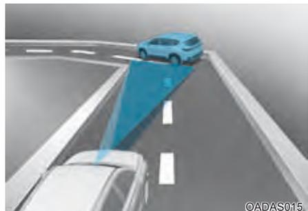
A velocidade do seu veículo pode ser reduzida devido a um veículo na faixa ao lado.
