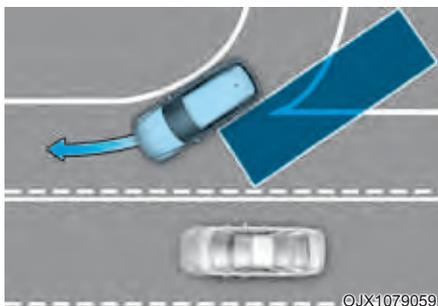
O Sistema de Alerta e Assistente de Ponto Cego pode não funcionar adequadamente ao dirigir onde a pista se funde/divide. A função pode não detectar o veículo da faixa ao lado.
