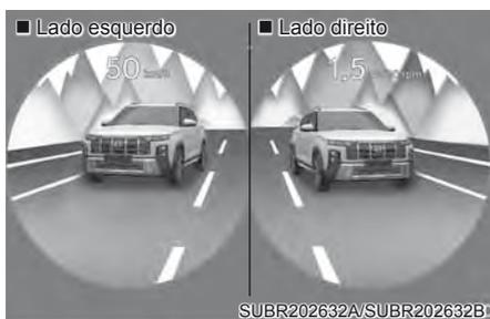
O Monitor de Visão do Ponto Cego mostra o ponto cego na área traseira do veículo no painel de instrumentos quando os indicadores de direção estiverem ligados para ajudar a mudar de faixa com segurança.
