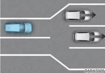
Se você passar por uma cabine de pedágio ou cruzamento com muitos veículos ou você dirigir onde as faixas se fundem frequentemente, o Alerta de Saída do Veículo à Frente pode não funcionar adequadamente.
