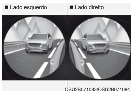
O Monitor de Visão do Ponto Cego mostra o ponto cego na área traseira do veículo no painel de instrumentos quando os indicadores de direção estiverem ligados para ajudar a mudar de faixa com segurança.
