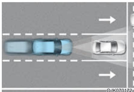
O sistema de alerta e frenagem autônomo é projetado para ajudar a detectar e monitorar o veículo à frente ou ajudar a detectar um pedestre ou ciclista na via, advertindo o motorista que uma colisão é iminente e, se necessário, com uma mensagem de advertência, uma advertência audível e aplicando a frenagem de emergência.
