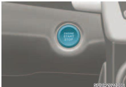
Com o interruptor de ignição desligado e todas as portas travadas, quando o motorista destravar o veículo com a chave inteligente e abrir a porta, o botão de Start/Stop acenderá por 30 segundos.
