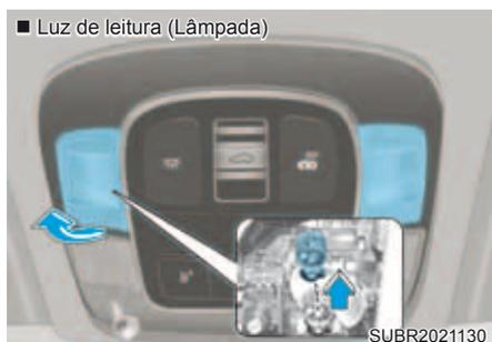
1. Remova a cobertura frontal e encontre 2 parafusos de fixação à carroceria.
