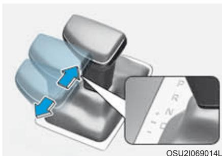
Se o veículo estiver parado ou em movimento, o modo de mudança manual é selecionado pressionando a alavanca de mudança da posição “D” (Condução) no trilho manual. Para voltar ao funcionamento em “D” (Condução), pressione a alavanca de mudança de volta ao trilho principal.
