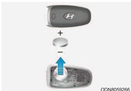
Se a chave inteligente não estiver funcionando corretamente, tente substituir a bateria por uma nova.
