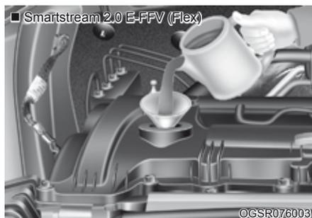
Se o nível estiver abaixo ou muito próximo da marca "L" ("LOW" nível mínimo), adicione óleo até que atinja a marca "F" ("FULL" nível máximo). **Não adicione óleo em excesso.**
