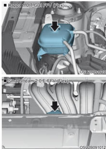
Verifique a condição e as conexões de todas as mangueiras do sistema de arrefecimento e de aquecimento. Troque as mangueiras deformadas ou deterioradas.
