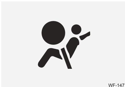
A luz de advertência do airbag no painel de instrumentos alerta o condutor sobre um problema potencial com o Sistema Suplementar de Proteção SRS AIRBAG.
