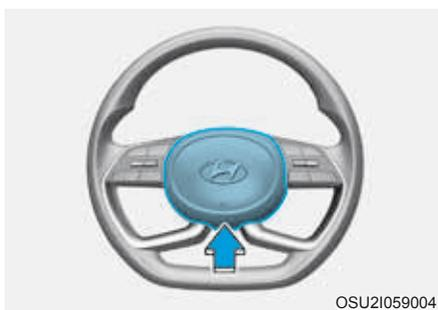
Para acionar a buzina, pressione a área indicada pelo símbolo da buzina no volante de direção (veja a ilustração). A buzina só funcionará quando esta área for pressionada.
