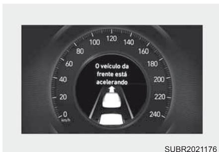
Após o veículo à frente sair, a mensagem é exibida no painel de instrumentos com o alarme.
