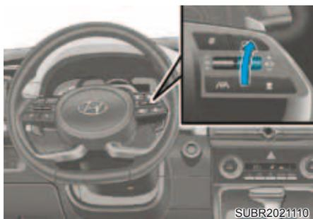
Pressione o interruptor para cima (+) ou para baixo (-) Se a velocidade do veículo for superior a 30 km/h, o veículo retorna à velocidade pré-ajustada.
