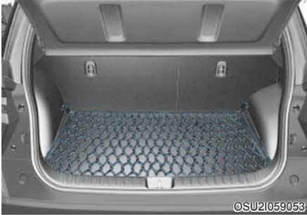
Para evitar que itens mudem de posição na área de carga, você pode usar os quatro suportes localizados na área de carga para prender a rede de bagagem.
