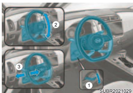
Para mudar a inclinação e a altura do volante de direção:
