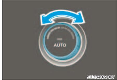
2. Ajuste o botão de controle de temperatura na temperatura desejada. Se a temperatura for ajustada no mais baixo (LO), o sistema de ar condicionado funcionará continuamente.
