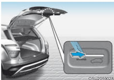
Seu veículo é equipado com uma alavanca de Liberação de Segurança de Emergência da tampa traseira localizada no fundo da tampa traseira. Quando alguém ficar preso inadvertidamente no compartimento de bagagem, a tampa traseira poderá ser aberta como segue:
