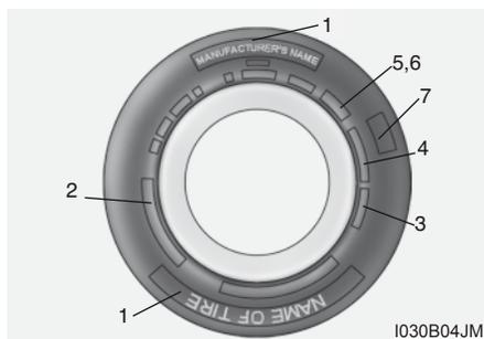
Essas informações identificam e descrevem as características fundamentais do pneu e fornecem número de identificação do pneu (TIN) para a certificação do padrão de segurança. O número de identificação do pneu (TIN) pode ser usado para identificar o pneu no caso de um “recall”.
