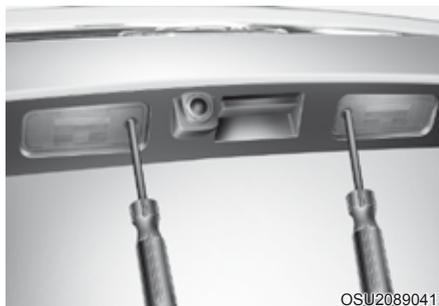
1. Solte os parafusos de fixação das luzes utilizando uma chave Philips.
