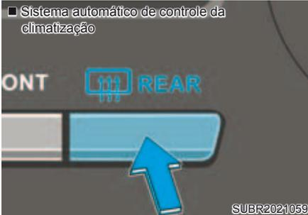
O desembaçador aquece o vidro para remover geada, neblina e gelo fino do interior e exterior do vidro traseiro enquanto o motor estiver funcionando.
