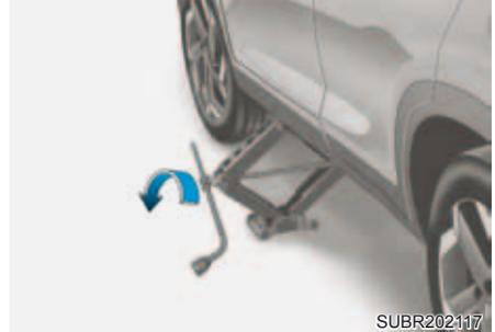
7. Posicione o macaco na posição mais próxima designada debaixo do chassi para levantar o pneu que irá substituir. Os pontos de apoio do macaco são placas soldadas à carroceria com duas linguetas e um ponto levantado. Nunca use o macaco em outra posição ou parte do veículo.
