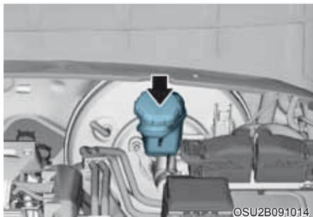
Verifique periodicamente o nível do fluido no reservatório. Ele deve estar entre as marcas “MIN” (mínimo) e “MAX” (máximo) existentes na lateral do reservatório.
