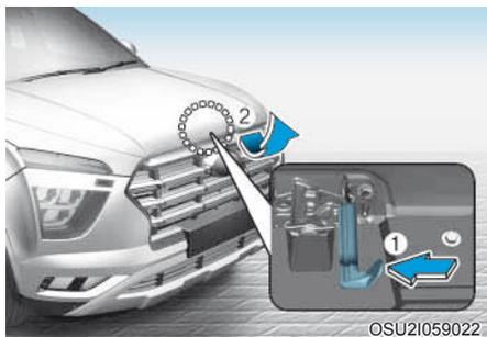
3. Vá para a frente do veículo, levante ligeiramente o capô, puxe a trava secundária (1) na parte interna do centro do capô e levante o capô (2).
