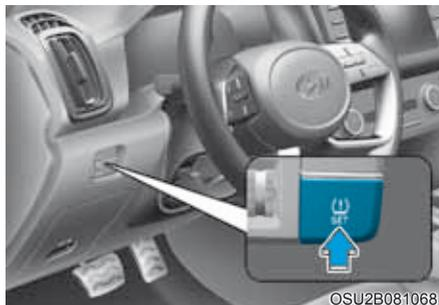
Após calibrar os pneus é necessário memorizar novamente a pressão dos pneus no sistema TPMS.
