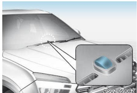
Nunca coloque nada perto do sensor localizado sobre o painel para garantir melhor controle do sistema de aquecimento e refrigeração.
