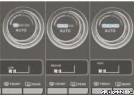
Você pode controlar a força do vento em três estágios pressionando o botão AUTO durante o funcionamento automático.
