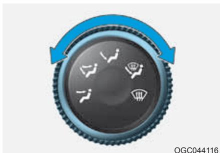
O botão de seleção de modo controla a direção do fluxo de ar através do sistema de ventilação.
