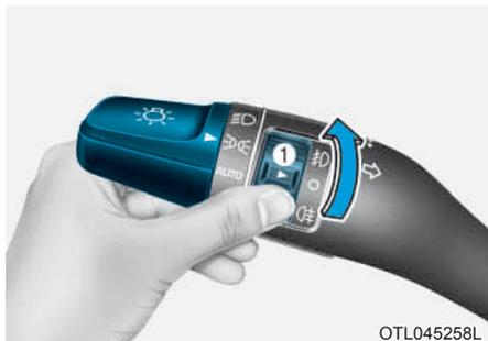
Luzes dos faróis de neblina são usadas para fornecer visibilidade melhorada quando a visão estiver comprometida devido à neblina, chuva ou neve etc. Use o interruptor próximo ao interruptor dos faróis altos para acender e apagar as luzes dos faróis dianteiros de neblina.
