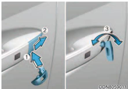
Gire a chave em direção à traseira do veículo para destravar e em direção à frente do veículo para travar.
