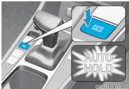
1. Com a porta do motorista e o capô do motor fechados, pressione o pedal do freio e então aperte o interruptor do [AUTO HOLD]. O indicador branco do AUTO HOLD acenderá e o sistema ficará na posição parado.
