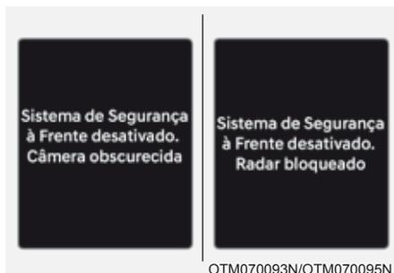
Quando o para-brisa onde a câmera dianteira estiver localizada, a tampa do radar dianteiro ou o sensor estiver recoberto por material estranho, como neve ou chuva, isso poderá reduzir o desempenho de detecção e limitar ou desativar o sistema de alerta e frenagem automático.
