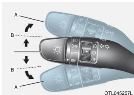
Para sinalizar uma curva, pressione para baixo a alavanca para fazer curvas à esquerda e para cima para curvas à direita na posição (A).
