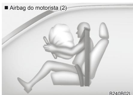
Após inflar, as costuras moldadas diretamente nas capas das almofadas se separam sob a pressão da expansão dos airbags. A abertura das capas permite o enchimento total dos airbags.
