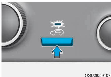
O controle de entrada de ar é usado para selecionar a posição do ar externo (fresco) ou posição de ar recirculado.
