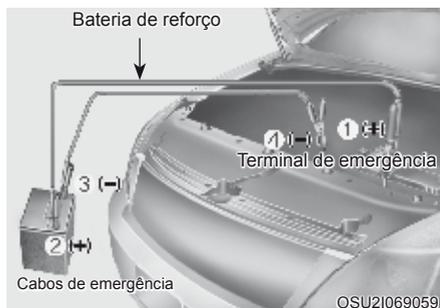
4. Conecte os cabos auxiliares na sequência exata mostrada na ilustração. Primeiro conecte um cabo auxiliar ao terminal positivo vermelho (+) do seu veículo (1).
