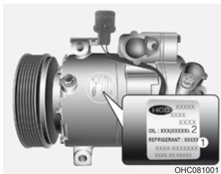
Uma etiqueta do compressor informa o tipo de compressor com que seu veículo está equipado, tal como modelo, números de peça do fornecedor, número de produção, refrigerante (1) e óleo refrigerante (2).
