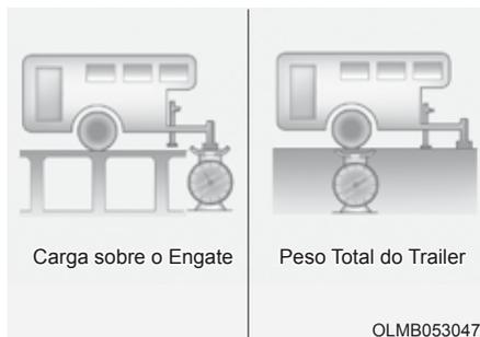
Existe um peso máximo seguro de um trailer? Ele nunca deve pesar mais do que o peso máximo do trailer com freios. Porém mesmo isso pode ser muito pesado. Depende de como você planeja usar o trailer. Por exemplo, a velocidade, altitude, inclinações do pavimento, temperatura externa e a frequência com que seu veículo é usado para puxar um trailer são muito importantes. O peso ideal do trailer também pode depender de qualquer equipamento especial existente no veículo.
