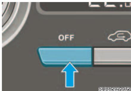
Para desligar o sistema de controle de climatização, pressione o botão OFF. Você pode continuar utilizando o modo e os botões de entrada de ar enquanto o interruptor de ignição estiver na posição ON.
