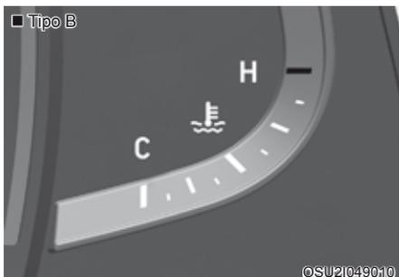
Este indicador exibe a temperatura do líquido de arrefecimento do motor quando o interruptor de ignição estiver na posição “ON”.
