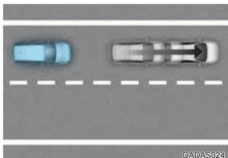
Se um veículo à frente mudar de faixa repentinamente, o Alerta de Saída do Veículo à Frente pode não funcionar adequadamente.
