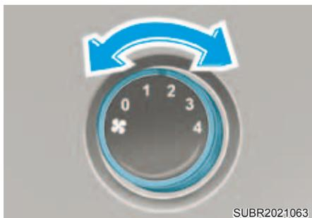
Gire o botão à direita para aumentar a velocidade do ventilador e o fluxo de ar. Gire o botão à esquerda para diminuir a velocidade do ventilador e o fluxo de ar.
