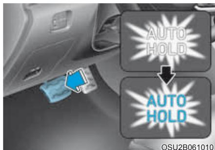
2. Quando você parar totalmente o veículo pressionando o pedal do freio, o AUTO HOLD mantém a pressão do freio para manter o veículo estacionado. O indicador muda de branco para verde.
