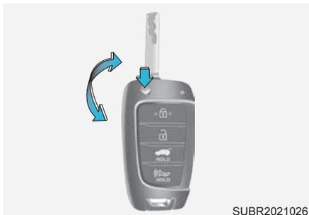
Se o transmissor não funcionar normalmente, você pode travar ou destravar as portas usando a chave mecânica.
