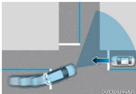
A função de Curva em Junção ajudará a evitar uma colisão com um veículo vindo em sentido contrário em uma faixa próxima em um cruzamento com o indicador de direção ligado aplicando a frenagem de emergência.
