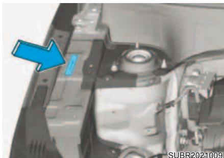
A etiqueta de identificação do veículo fixada na caixa de roda do lado do passageiro mostra o número de identificação do veículo (VIN).
