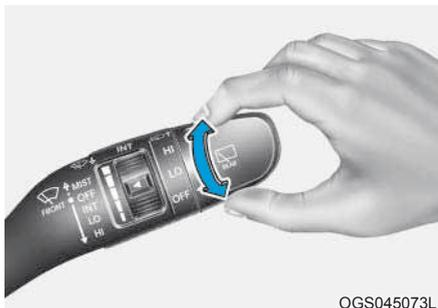
O interruptor do limpador e lavador do vidro traseiro está localizado na extremidade da alavanca do interruptor do limpador e lavador
