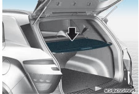
Use a tampa para ocultar itens armazenados na área de carga.
