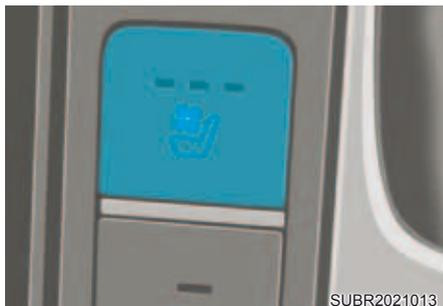
O banco com ventilação de ar é fornecido para resfriar o banco do motorista soprando ar através de pequenos orifícios de ventilação na superfície do assento e encosto do banco.
