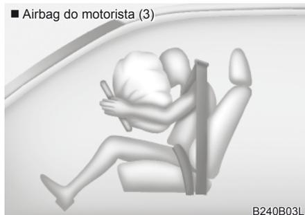
Um airbag totalmente inflado, combinado com o cinto de segurança usado corretamente, reduz o movimento para frente do motorista ou passageiro dianteiro, diminuindo o risco de ferimento na cabeça e no peito.
