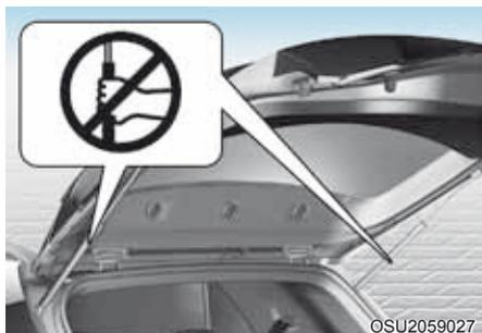
Não segure nas molas a gás (levantadores) que suportam a tampa traseira. Lembre-se que a deformação da peça pode causar dano ao veículo e risco de ferimento.
