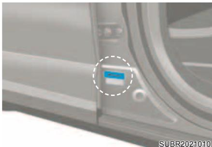
A etiqueta de certificação do veículo afixada na coluna central do lado do motorista (ou passageiro dianteiro) contém o número de identificação do veículo (VIN).
