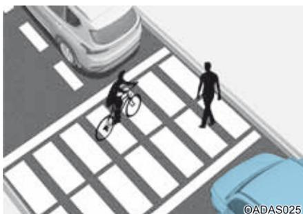
Se existir um pedestre ou uma bicicleta entre seu veículo e o veículo à frente, o Alerta de Saída do Veículo à Frente pode não funcionar adequadamente.
