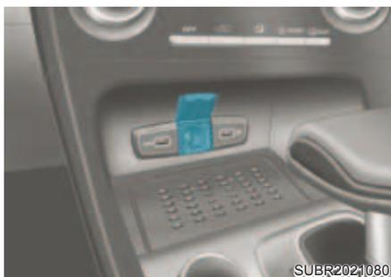
A tomada de força foi projetada para fornecer energia elétrica para telefones celulares ou outros equipamentos desenvolvidos para funcionar com os sistemas elétricos do veículo. Os equipamentos deverão consumir menos que 180 Watts com o motor em funcionamento.
