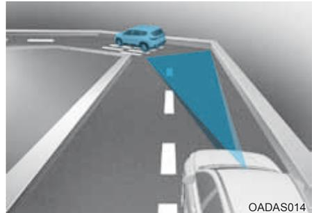
Em curvas, o Controle de Cruzeiro Inteligente pode não detectar um veículo na mesma faixa e pode acelerar até à velocidade ajustada. A velocidade do veículo também poderá diminuir rapidamente quando o veículo à frente for detectado repentinamente.
