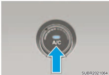
Para ligar o sistema de ar condicionado, pressione o botão "A/C" (a luz indicadora acenderá). Para desligar o sistema de ar condicionado, pressione novamente o botão.
