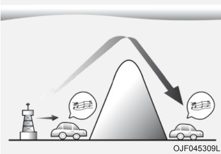
Transmissões em AM podem ser recebidas em maiores distâncias do que transmissões em FM. Isto porque as ondas de rádio AM são transmitidas em baixas frequências. Estas ondas longas e de baixa frequência têm a capacidade de acompanhar a curvatura da Terra, sendo repetidas na atmosfera. Além disso, elas contornam obstáculos e asseguraram melhor cobertura do sinal.
